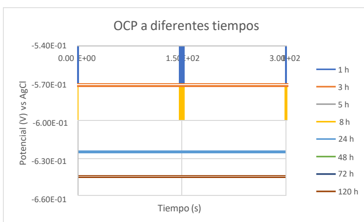
Figura 5. Potencial a circuito abierto del acero API 5L X70 inmerso en una solución de cloruro de sodio al 3% con una concentración de inhibidor de 50 ppm en el tiempo de 0 h.
