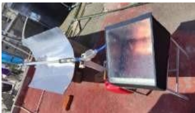
Figura 1. Sistema acoplado de calentamiento-distilación solar
