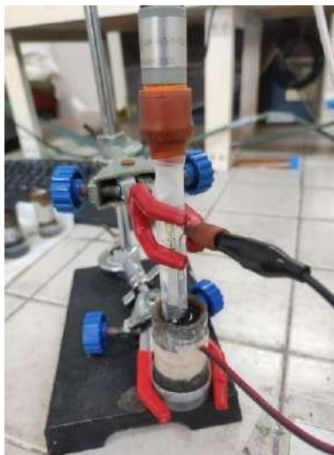
Figura 1. Montaje experimental empleado para el monitoreo del OCP en tuberías de acero con una incrustación calcárea como electrodos de trabajo.
