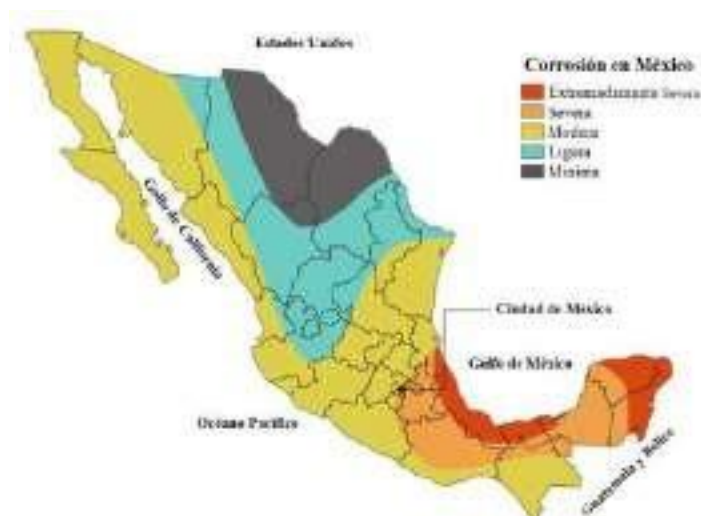
Figura 2. Corrosión de México, [12].
