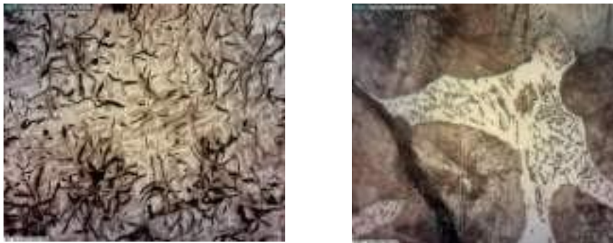
Figuras 2. Micrografía óptica Microestructura del hierro gris con ataque izquierda 5X aumentos, derecha a 100X
