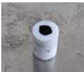
Figura 3. Electrodo de carbón vítreo con la tinta depositada.
