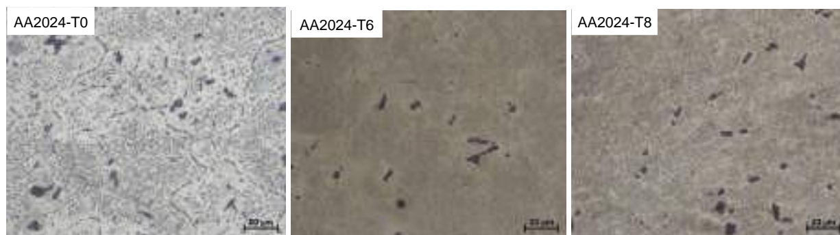
Figura 5. Microestructuras de la aleación AA2024 en las tres condiciones de tratamiento térmico
