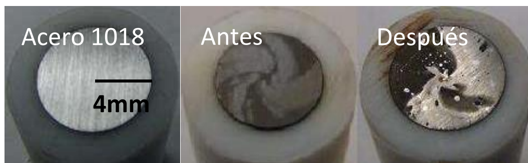
Figura 5. Imágenes ópticas del acero 1018 expuesto en emulsiones estimuladas después de 1 h, antes y después del proceso de desalado.
