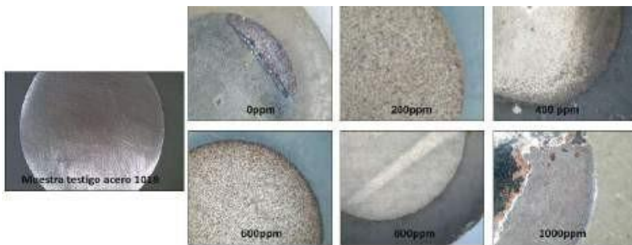
Figura 4. Imágenes obtenidas del acero AISI 1018 en 1 M HCl a 25°C antes y después de las técnicas electroquímicas mediante un microscopio digital.
