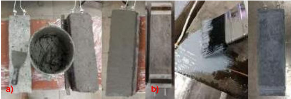
Figura 1. Colocación de sistemas anódicos.
