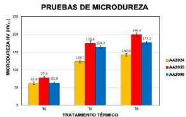
Figura 4. Resultados de pruebas de micro dureza de aleaciones AA2024, AA2055 Y AA2099 en condiciones de tratamiento térmico T0, T6 y T8.
