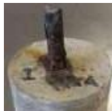
Figura 8. Especimen que muestra la aparición de gel obscuro en los alrededores del electrodo primario.
