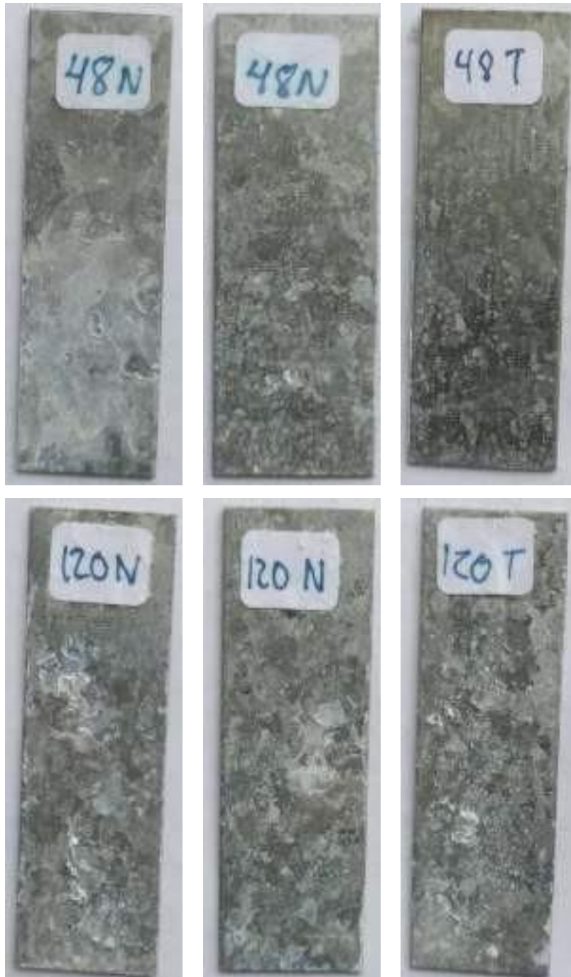
Figura 3. Corrosión atmosférica acelerada para piezas con y sin tratamiento de inhibición, con un tiempo de 48 horas.
