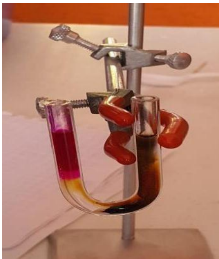
Figura 5. Celda electrolítica con sustancia oxidada y reducida.
