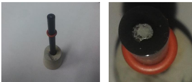
Figura 2. Electrodo de carbono vítreo con aglomerado de polvo de renio.
